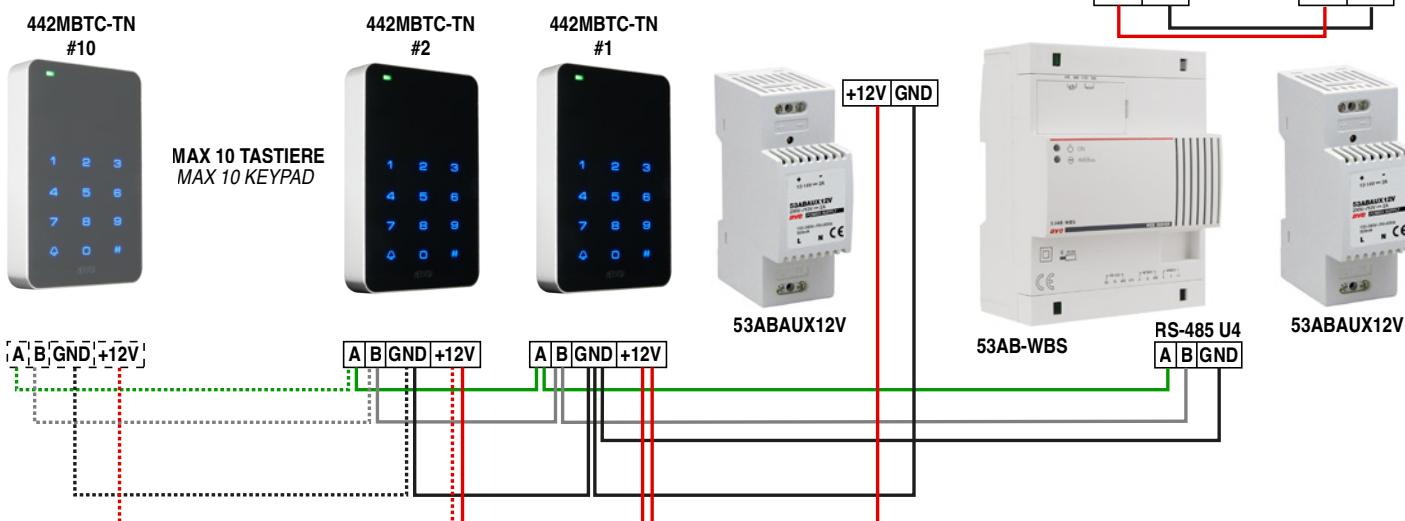
PER IL COLLEGAMENTO MODBUS UTILIZZARE CAVO 3X0,5mm<sup>2</sup> SCHERMATO FOR MODBUS CONNECTION USE 3X0,5mm<sup>2</sup> SHIELDED CABLE
