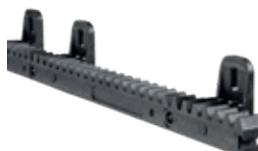
AJ91111 Cremagliera in fibra di nylon con anima in acciaio ed asola di fissaggi modulo 4 (ante max 600 Kg)
